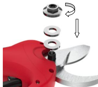
12.按照图示放入平面滚针轴承及 垫片, 并拧上锁紧螺母。
