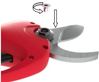
13.按照图示逆时针方向拧上 M5内六角沉头螺丝。
