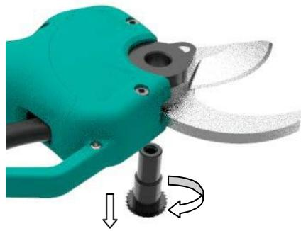
3.按照图示逆时针方向旋转拆去内六角螺栓。
